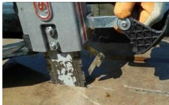
2. so durchstechen, dass der WallWalker für effizientes Schneiden eingesetzt werden kann (*Hebelsystem mit einer Kraftübertragung von 4 zu 1*) ; WallWalkerspitze im Schnitt fixieren, Säge einseitig drücken, um Vorschub zu ermöglichen
