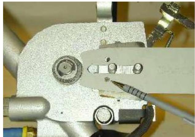
2. Lösen der Kettenradnutmuttern,
