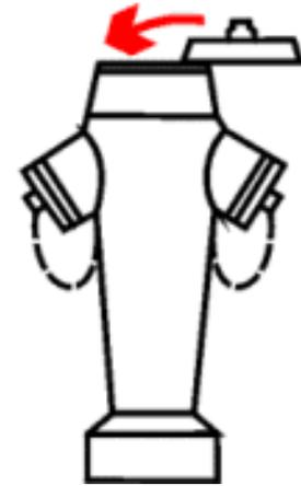
3. Seitenventile um Drehung öffnen, kontrollieren, ob Hydrant entleert
