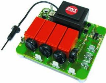
Thermofühler (*Schutz vor Überhitzung des Pumpenmotors bei Überlast*).
